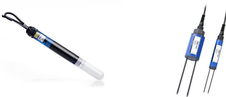
Abbildung 13: UMS-Tensiometer T8 (links) und TDR-Trime Sensoren (rechts)
