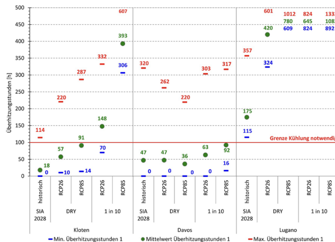
Illustration : Analyse des heures de surchauffe sur une durée d'utilisation de 3111 h (période 16.4.-15.10) à l'intérieur du bâtiment d'habitation test comprenant la proportion de fenêtres habituelle d'aujourd'hui, pour différents sites (Kloten, Davos et Lugano), sur la base des données historiques tirées du cahier technique SIA 2028 en vigueur et en fonction de différents scénarios d'émission (RCP2.6 et RCP8.5), pour une année normale (DRY) et pour une année exceptionnelle (en moyenne 1 année sur 10). Exemple d'interprétation : si l'on regarde la moyenne des heures de surchauffe (cercle vert), on constate que la limite de 100 h de surchauffe à partir de laquelle un refroidissement se révèle nécessaire est nettement dépassée dans le bâtiment test du site de Kloten pour l'année exceptionnelle (1 année sur 10). Source : HSLU
