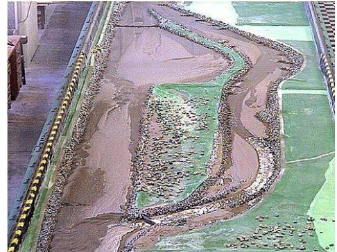
Modellversuch mit dem Geschiebeablagerungsraum links und dem Flusslauf rechts
